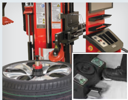
Aligner le capteur TPMS et enclencher WalkAway™
