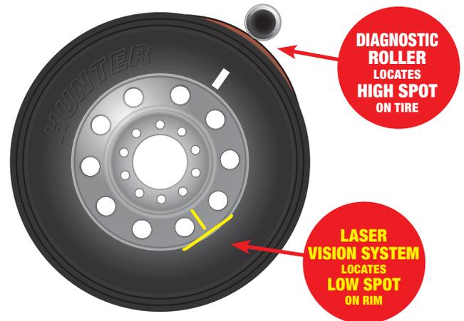
DIAGNOSTIC ROLLER LOCATES HIGH SPOT ON TIRE
