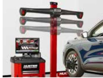
**Les configurations de caméras mobiles motorisées et manuelles** offrent une gamme complète de déplacements verticaux pour augmenter la hauteur de levage.
