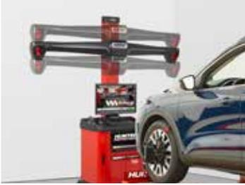
**La configuration montée sur armoire** permet le service dans plusieurs baies d'alignement et offre une gamme complète de déplacements pour une hauteur de pont supplémentaire..
