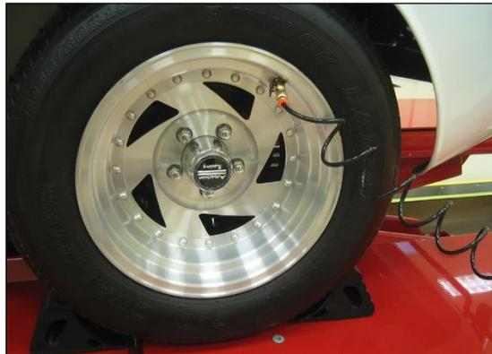
Utilice las flechas de control de ajuste en cada lado de las pantallas de presión para establecer la presión de la llanta deseada para cada eje.
