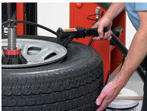
Schock-Befüllung - Schickt einen großen Luftstoß zur undichten Stelle.
