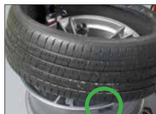
Montage unterer Wulst
