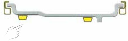
La vista en corte del rin muestra el modo de plomo seleccionado
