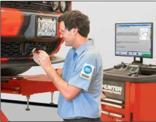
Un mayor número de vehículos incluyen sistemas avanzados de asistencia al conductor (SAAC). Aunado al alineamiento mecánico, las especificaciones del fabricante comúnmente requieren un Alineamiento del Sistema de Seguridad® en muchos vehículos equipados con sistemas SAAC.
